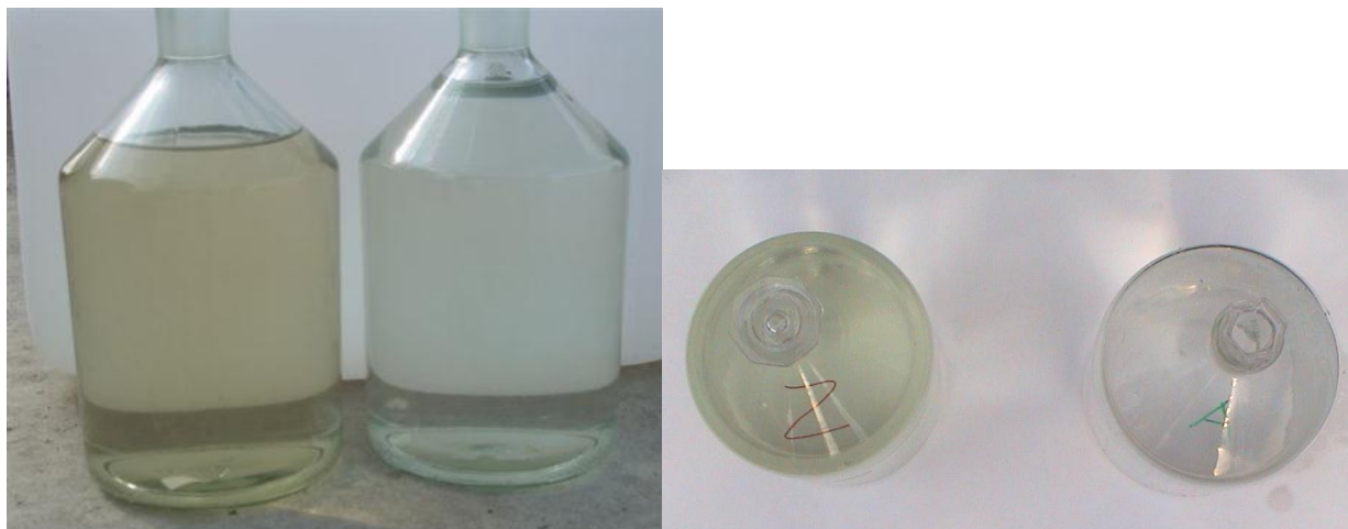
Abbildung 27 Kläranlagenablauf vor (in Fotos links, Z) und nach (in Fotos rechts, A) Ozonierung
